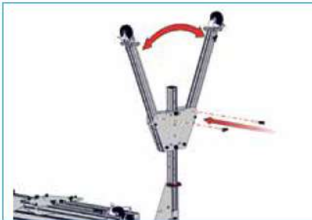
15. Vik ut benen och sätt in snabbkopplings-tapparna i det yttre hålet, för att säkra benet i öppet läge. Upprepa för andra benet på samma fästplåt till gavel.
