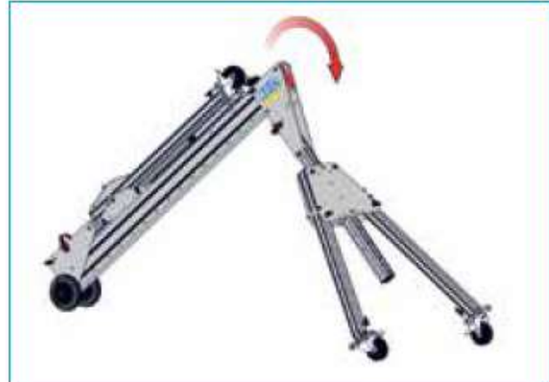
15. Baxa upp gaveln tills snabbkopplingstapparna kommer intill balken. Ta bort tappen och fortsätt rörelsen tills tappan passar i balken och hålen i fästplåtarna. Se steg 6 och 7.
