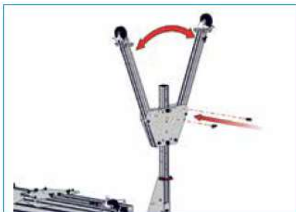
3. Vik ut benen och sätt in snabbkopplingstappen i det andra hålet och säkrar benet i "öppet" läge. Upprepa för andra benet på samma gavel.
