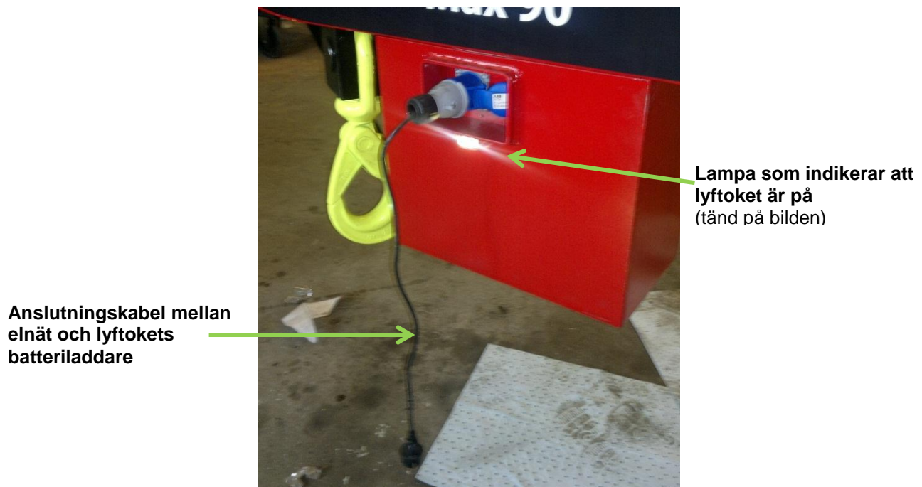
Figur 12 Anslutningskabel mellan elnät och lyftokets batteriladdare (lampan indikerar att lyftoket är på).
