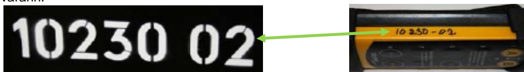
Figur 5 Samma registreringsnummer på lyftoket som dess tillhörande radiosändare.
