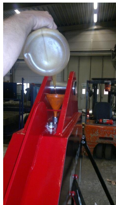
Figur 28 Exempel på påfyllning av hydraulolja
