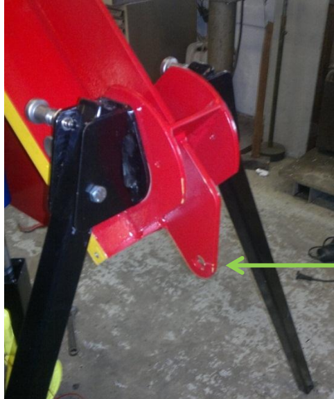
Figur 10 Sidhåll på lyftoket som kan förankras i lastbärare eller transportram.
